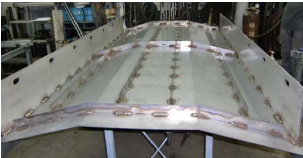
写真-4 落雪防止パネル 製作状況(写真は裏面)
