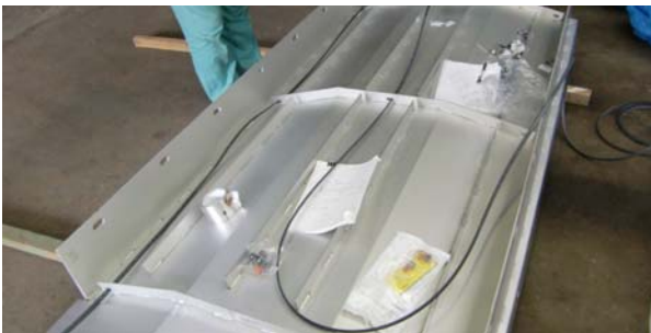
写真-5 落雪防止パネル 線状ヒーター配置(裏面)
