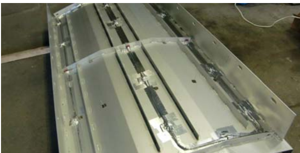
写真-6 落雪防止パネル 線状ヒーター固定(裏面)
