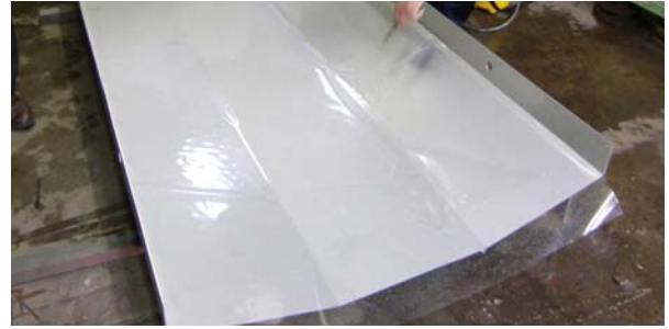
写真-8 落雪防止パネル 光触媒防汚フィルム(表面)
